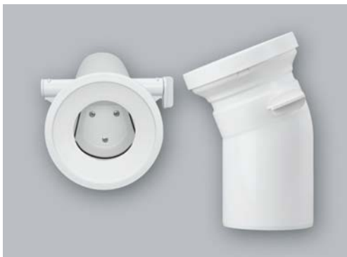
58.112.01..0099 Kolanko połączeniowe 22° z blokowaną klapą przeciwszczurową. DN 100, biel alpejska.
