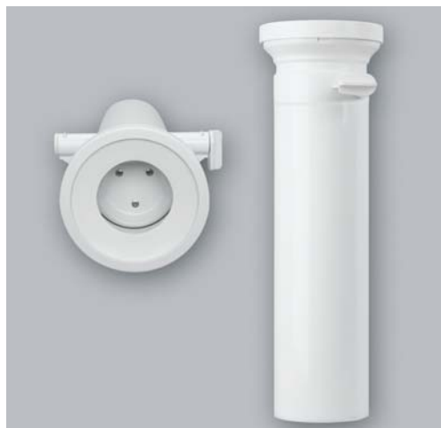
58.213.01..0000 Kolanko połączeniowe 400 mm z blokowaną klapą przeciwszczurową. DN 100, biel alpejska.
