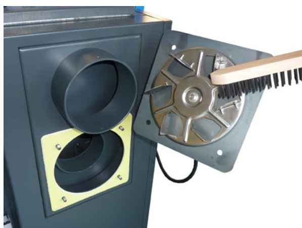
Czyszczenie zdania i kontroli pion ostrza wirnika wentylatora wyciągowego
