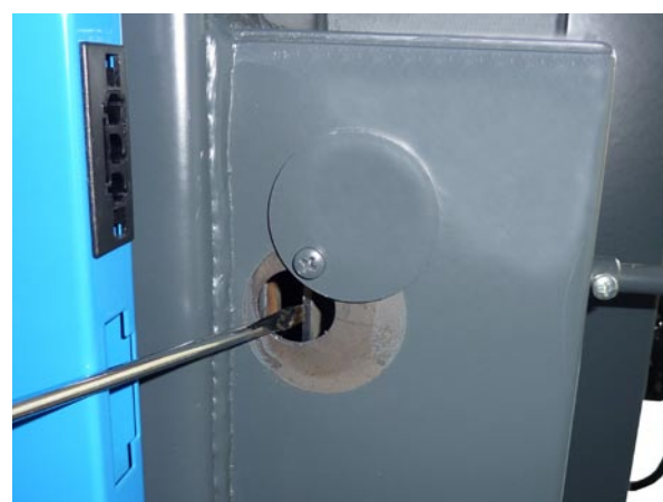
Sprawdzanie i czyszczenie stosunek kontroli powietrza pierwotnego i wtórnego wyczystka
