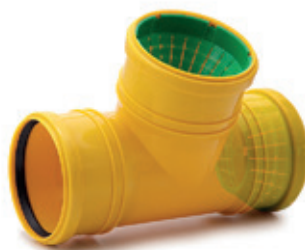
KDR 27 trójnik drenarski uniwersalny z przyłączem \varnothing 110 łączy rury drenarskie od \varnothing 72 do \varnothing 100 mm z rurą litą \varnothing 110
