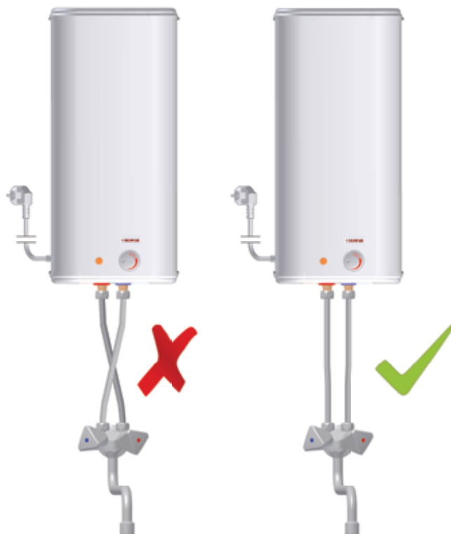
Rys 5. Prawidłowe połączenie podgrzewacza z baterią wodną.
